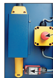
Fig. 9 Interruptor de anulación del modo de "funcionamiento automático" y parada de emergencia.
